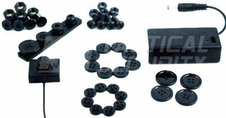
Del botón se desprende un delgado cable para ser introducido por la ropa hasta el bolsillo o la espalda donde se puede portar la grabadora digital.
